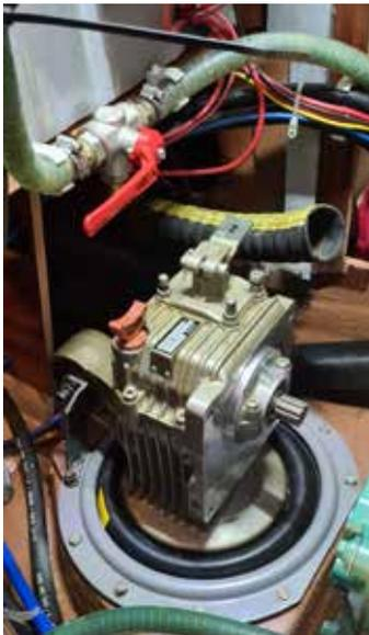
Mit neuer Manschette versehen, ist der Wiedereinbau des Getriebes nicht ganz trivial, da beim Zusammenfügen von Getriebe und Motor die Motorachse dreidimensional auf das Getriebe ausgerichtet und auch die
